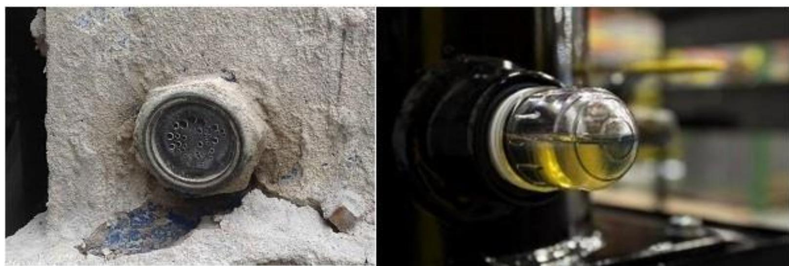
Figura 3: Reemplazar una mirilla plana con una mirilla 3D es una modificación simple y económica que puede mejorar en gran medida la confiabilidad de las revisiones del nivel de aceite.
