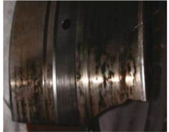
Fig. Perdida de ajuste de interferencia entre el eje y el aro exterior, provocando fractura.
