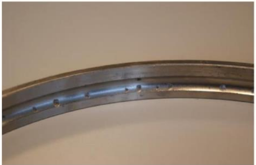
Fig. Voltaje excesivo en rodamiento, provocando pitting localizado. (fuente NSK)
