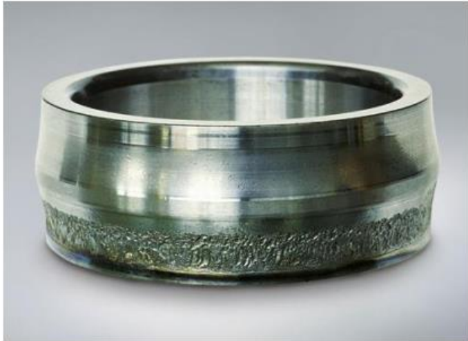
Fig. Rodamiento con fallo prematuro debido a una sobrecarga provocado por desalineación. (fuente NSK)
