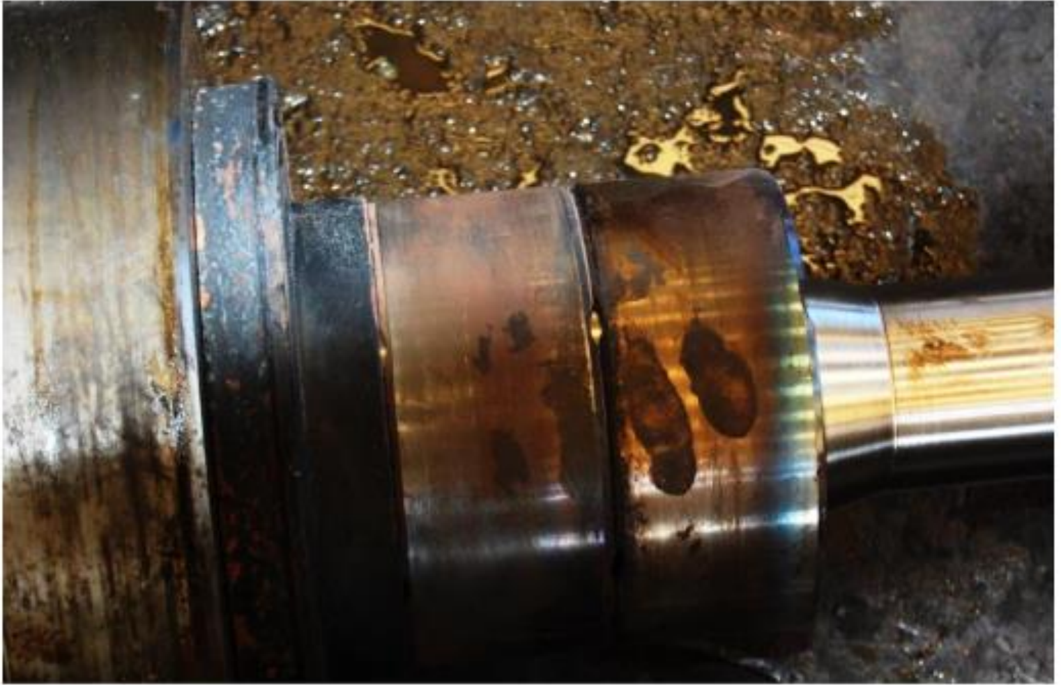
Fig. Perdida de dureza debido a calentar el rodamiento para su montaje sin controlar la temperatura.
