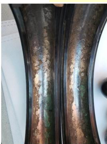
Fig. Falla en rodamiento por exceso de grasa, cambio en la coloración de los caminos de
