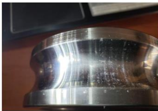
Fig. Ralladuras longitudinales, espaciadas a la altura de los elementos rodantes.
