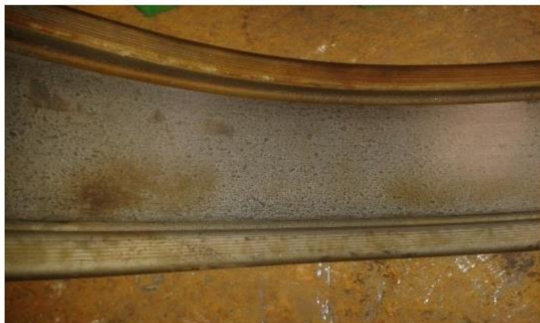
Fig. Indentaciones generadas por ingreso de agua en el rodamiento.
