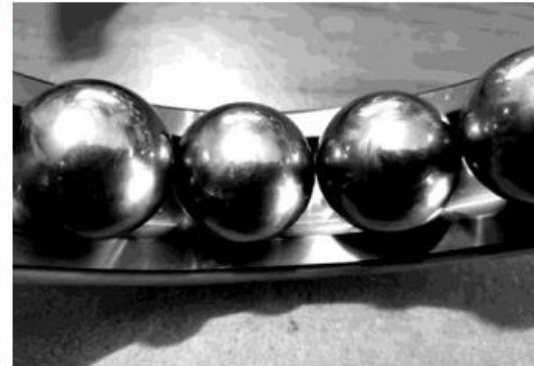
Fig. Elementos rodantes con daños focalizados al no estar girando presentan marcas, equipo de respaldo
