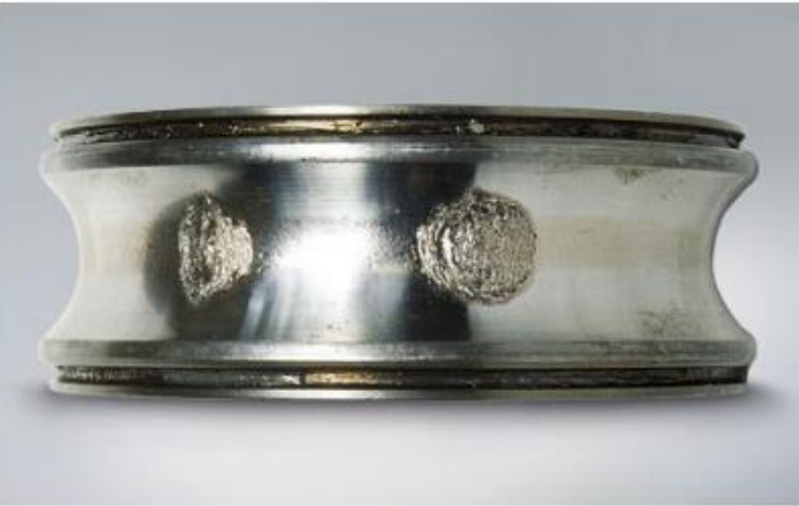
Fig. Elementos rodantes impresos en los caminos de rodadura provocado por un montaje inadecuado. (fuente NSK)
