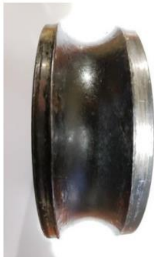
Fig. Aumento de temperatura en los caminos de rodadura debido a una escasez de lubricante.
