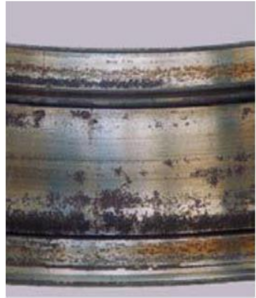
Fig. Ingreso de agua en bomba de respaldo. (fuente SKF)
