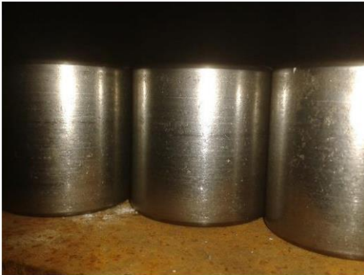
Fig. Picaduras en rodillos debido al ingreso de contaminantes.
