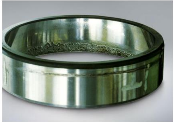
Fig. Rodamiento con fallo prematuro debido a una sobrecarga provocado por desalineación. (fuente NSK)
